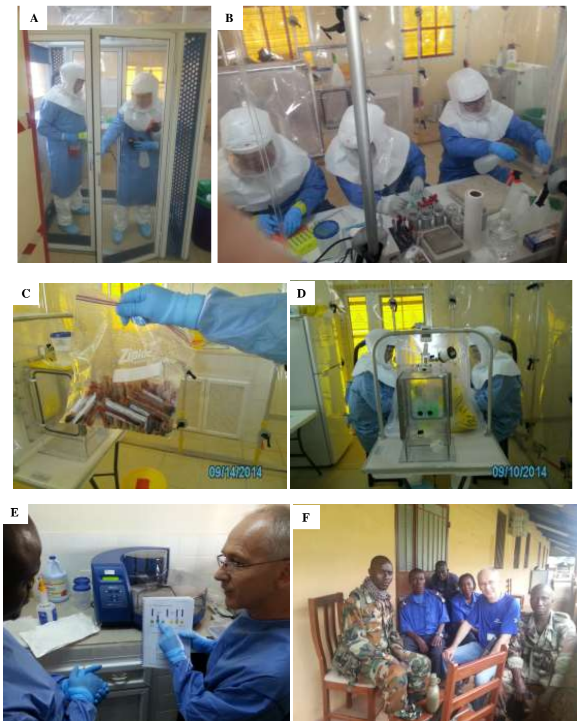
Ryc. 2. NICD/NHLS polowe laboratorium BSL3 do molekularnej diagnostyki zakażeń wirusem Ebola, Freetown, Sierra Leone, Zachodnia Afryka. A - wejście operatorów w ubiorach ochronnych z urządzeniem do filtracji powietrza przez służę do komory z podciśnieniem zapewniającym trzecią klasę bezpieczeństwa biologicznego; B - identyfikacja i przygotowanie prób klinicznych do ekstrakcji wirusowego RNA; C - próbki krwi pobrane od pacjentów podejrzanych o zakażenie wirusem Ebola; D - "gorąca" ekstrakcja RNA z prób krwi w komorze izolacyjnej pod negatywnym ciśnieniem; E - szkolenie lokalnego personelu medycznego w molekularnych technikach diagnostycznych EVD; F – Prof. J. Pawęska z grupą żołnierzy i służb ochrony odpowiedzialnych za ochronę laboratorium.
